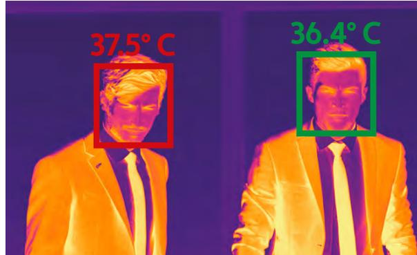
Estos terminales, que soportan varios métodos de verificación, (tarjeta, cara y temperatura), cuentan con un rango de detección de temperatura de entre 30°C a 45°C y una distancia de autenticación entre los 0,3 y los 2 metros. Todo ello, logrando alcanzar un nivel de precisión en la detección de temperatura de  $\pm 0.5$  °C, convirtiéndose en un sistema de detección preliminar de primer orden.
